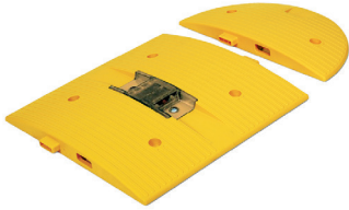
11938 SL En/W Boy/L Yüksek/H 500 x 500 x 45 mm Ağırlık / Weight 3,10 Kg Material : PPC Solar Güçlü Çalışan 6 Led. Solar Powered Warning Flasher.
