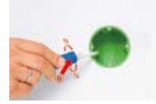
E25-COS Koaksiyal kabloların (örneğin anten ve transmisyon kabloları) iki ya da üç kademeli sıyırılması
